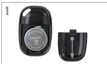
1 Para introducir o cambiar la batería, ponga el pulgar en el centro de la cubierta posterior, presionando hacia dentro y deslizando hacia abajo para sacar la tapa de la batería. La batería CR2032 debería introducirse con el lado positivo (+) orientado hacia fuera. Vuelva a colocar la cubierta.
