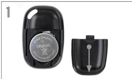
1 Um die Batterie einzulegen oder auszutauschen, legen Sie Ihren Daumen auf die Mitte der hinteren Abdeckung, drücken Sie nach innen und schieben Sie den Batteriefachdeckel nach unten, um ihn zu entfernen. Die CR2032-Batterie muss mit dem Pluspol (+) nach oben eingelegt werden. Setzen Sie den Batteriefachdeckel wieder ein.
