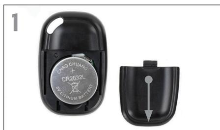
1 Per inserire o sostituire la batteria, porre il proprio pollice al centro del coperchio posteriore, premere in avanti e far scorrere verso il basso per rimuovere il coperchio della batteria. La batteria CR2032 deve essere inserita con il lato positivo (+) rivolto verso l'alto. Riposizionare il coperchio.
