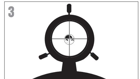
3 Regardez dans le chercheur et localisez le réticule du viseur. Continuez à orienter le télescope jusqu'à ce que le viseur soit superposé sur la Lune.
