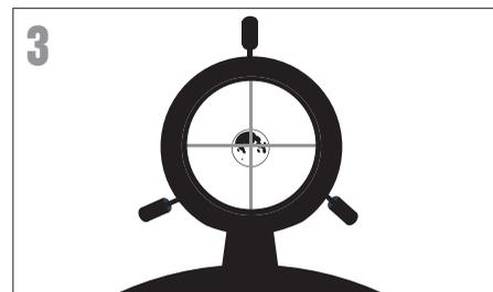
3 Schauen Sie durch das Sucherfernrohr und suchen Sie das Fadenkreuz. Schwenken Sie das Teleskop weiter, bis das Fadenkreuz über dem Mond erscheint.
