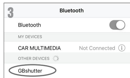
3 Use la configuración Bluetooth del teléfono para emparejar el dispositivo «GBshutter».
