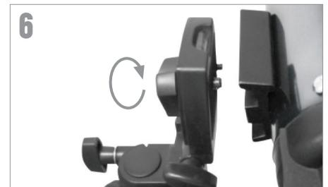
Passen Sie die Gewindeschraube in der Montageplattform an die Gewindebohrung am Boden des Teleskoptubus an und schrauben Sie beide zusammen. Nicht überdrehen. Diese müssen eng anliegen, aber nicht zu fest.
