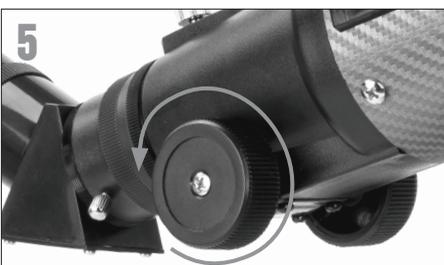
5 Utilizzare il focalizzatore del telescopio per regolare la messa a fuoco della propria fotocamera. Scattare usando la propria app.
