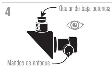
4 Mire por el ocular de 20mm del telescopio. Gire suavemente los mandos de enfoque para ajustar la definición de la imagen.
