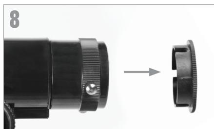
Entfernen Sie die Kappe vom Fokussierende des Teleskoprohres und stellen Sie sicher, dass die beiden Rändelschrauben nicht in die Öffnung hineinragen.
