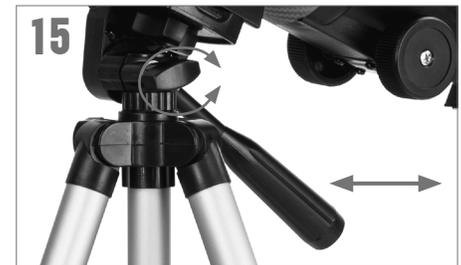
Per muovere il telescopio a sinistra e destra, mantenere una gamba del treppiedi con una mano mentre con l'altra si usano le manopole di panoramica per spostare il telescopio. La vite di blocco dell'azimut può essere allentata o serrata per regolare la tensione secondo le proprie preferenze.
