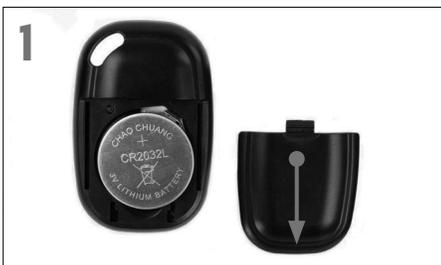
Para introducir o cambiar la batería, ponga el pulgar en el centro de la cubierta posterior, presionando hacia dentro y deslizando hacia abajo para sacar la tapa de la batería. La batería CR2032 debería introducirse con el lado positivo (+) orientado hacia fuera. Vuelva a colocar la cubierta.
