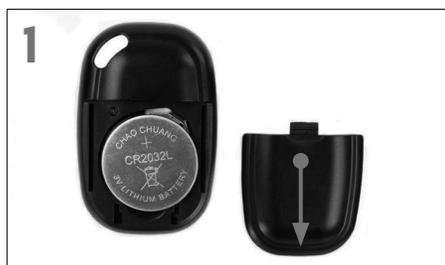
Per inserire o sostituire la batteria, porre il proprio pollice al centro del coperchio posteriore, premere in avanti e far scorrere verso il basso per rimuovere il coperchio della batteria. La batteria CR2032 deve essere inserita con il lato positivo (+) rivolto verso l'alto. Riposizionare il coperchio.
