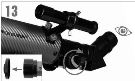
Rimuovere i cappucci dell'obiettivo dalla parte anteriore del telescopio. Per osservare, guardare attraverso l'oculare come mostrato. Mettere a fuoco l'immagine ruotando le manopole al di sotto del focalizzatore.
