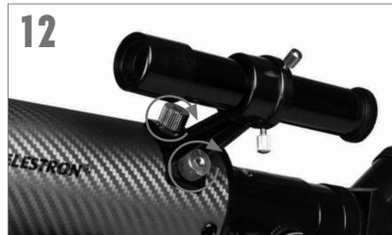
Localice el localizador y saque las tapas de plástico en la parte anterior y posterior de la lente. Oriente el localizador de forma que la lente más grande esté orientada a la parte anterior del tubo del modo indicado. Ponga el localizador sobre los postes del tubo y coloque las roscas estriadas para asegurarlo en posición.
