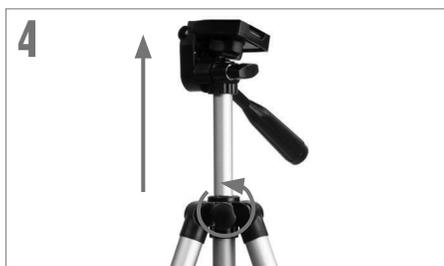
Per estendere il montante centrale del treppiedi, ruotare la manopola di blocco in senso antiorario, sollevare la testa del treppiedi fino all'altezza desiderata e ruotare la manopola di blocco in senso orario per assicurarla.
