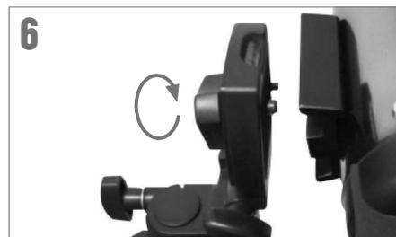
Passen Sie die Gewindeschraube in der Montageplattform an die Gewindebohrung am Boden des Teleskoptubus an und schrauben Sie beide zusammen. Nicht überdrehen. Diese müssen eng anliegen, aber nicht zu fest.
