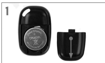
1 Pour installer ou remplacer la pile, posez votre pouce au centre du capot arrière, appuyez dessus puis faites-le glisser vers le bas pour retirer le cache d'accès à la pile. La pile CR2032 doit être insérée avec le pôle positif (+) tourné vers le haut. Remettez le cache en place.
