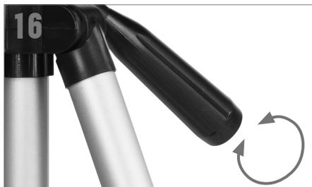
Per spostare il telescopio in alto e in basso, ruotare completamente la manopola di panoramica in senso antiorario e usare la manopola per puntare il telescopio nella direzione desiderata. Ruotare la manopola panoramica in senso orario per bloccarla in posizione.
