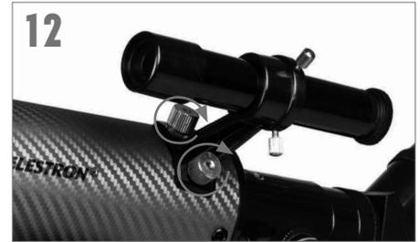
Nehmen Sie das Sucherfernrohr und entfernen Sie die Plastikkappen von den Linsen. Richten Sie das Sucherfernrohr so aus, dass die größere Linse zur Vorderseite des Tubus zeigt, wie dargestellt. Platzieren Sie das Sucherfernrohr über den Stützen des Tubus und setzen Sie die Rändelmuttern wieder ein, um es zu sichern.
